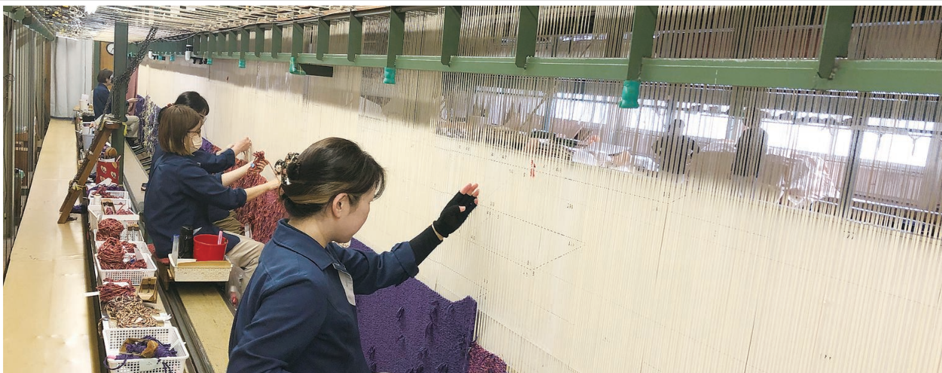
広幅の縦織織機で緞帳を製造
